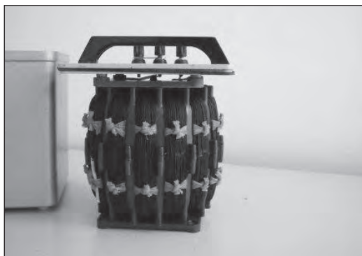
Obr. 2.7.1: Vnitřní konstrukce toroidního etalonu indukčnosti typu P5115.
