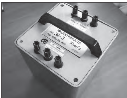
Obr. 2.7.2: Toroidní etalony indukčnosti pod 100 \mu\text{H} s potlačením vlivu indukčnosti přívodů
