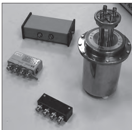
Obr. 2.5.8: Ukázky etalonů určených pro střídavý signál. Ve válcovém krytu vpravo je etalon s bifilární smyčkou z velmi tenkého drátu s vypočitatelnou frekvenční charakteristikou. Vlevo vzadu etalon s vypočitatelnou frekvenční charakteristikou s vrstevným odporem, uprostřed je etalon Agilent typu 42030A, v popředí širokopásmový etalon vlastní konstrukce ČMI
