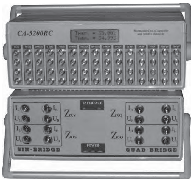
Obr. 4.2.3: Komparátor impedancí obsahující kvadrurní a poměrový most a sadu termostatovaných etalonů CA-5200RC
