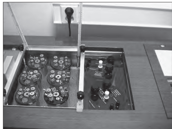
Obr. 2.5.6: Plně využit vlastností etalonů lze jenom jejich měřením v kvalitní termostátované olejové lázni
