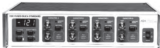
Obr. 2.6.3: Rám pro 4 křemenné etalony s termostaty
