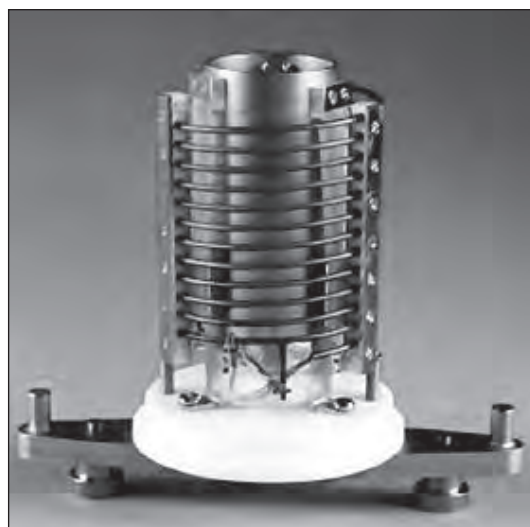
Obr. 2.5.15: Vnitřní provedení etalonu 1 \Omega z výroby metrologického institutu Austrálie
