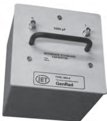
Obr. 2.6.5: Kondenzátory IET Lab plněné dusíkem s invarovými elektrodami
