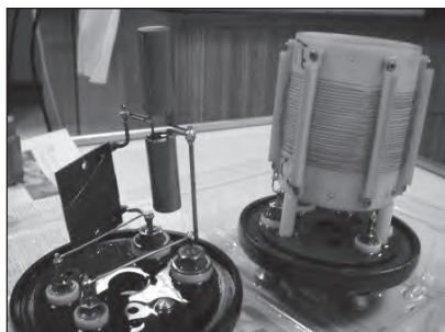
Obr. 2.5.5: Vnitřní konstrukce etalonů Tinsley
