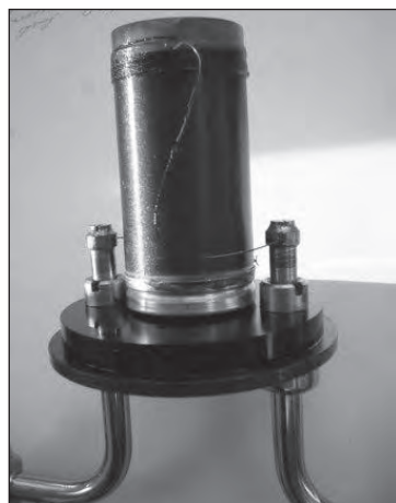
Obr. 2.5.1: Etalon odporu Metra 1 k \Omega
