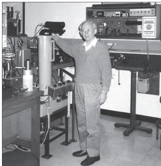
Obr. 2.2.5: TLE se svislými elektrodami používaný v NMIA v Lindfieldu
